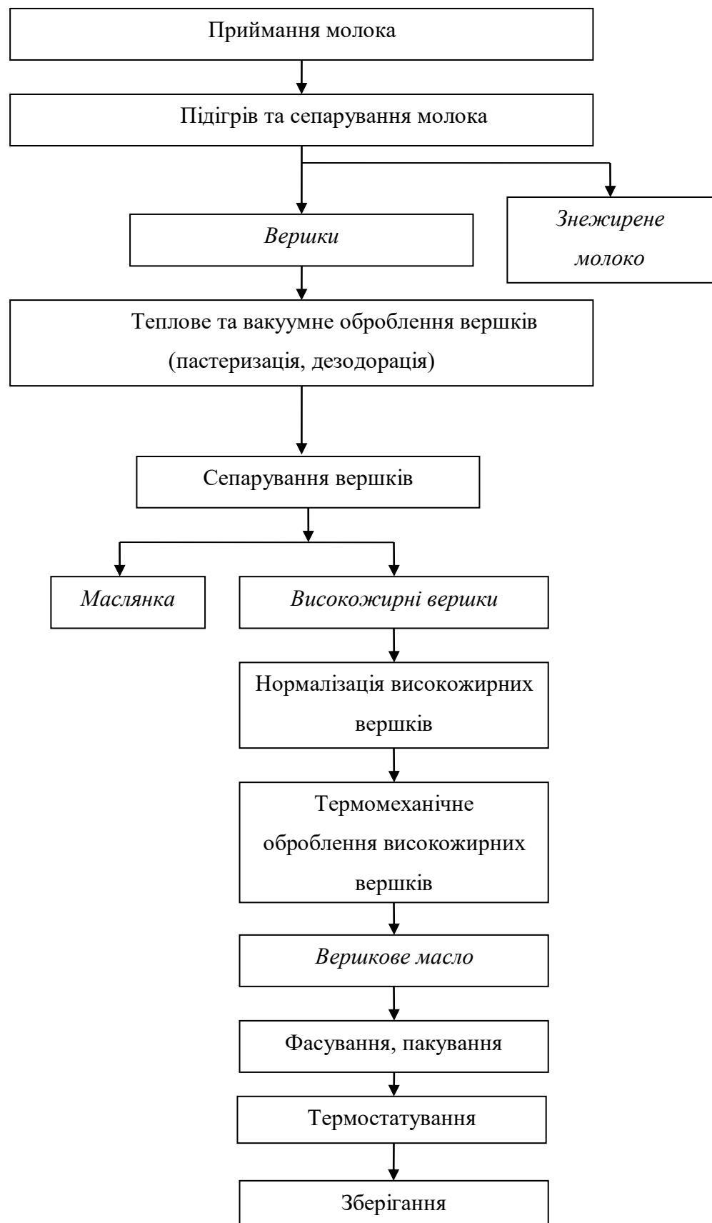
Рис. 1. Технологічна схема виробництва вершкового масла методом ПВЖВ
