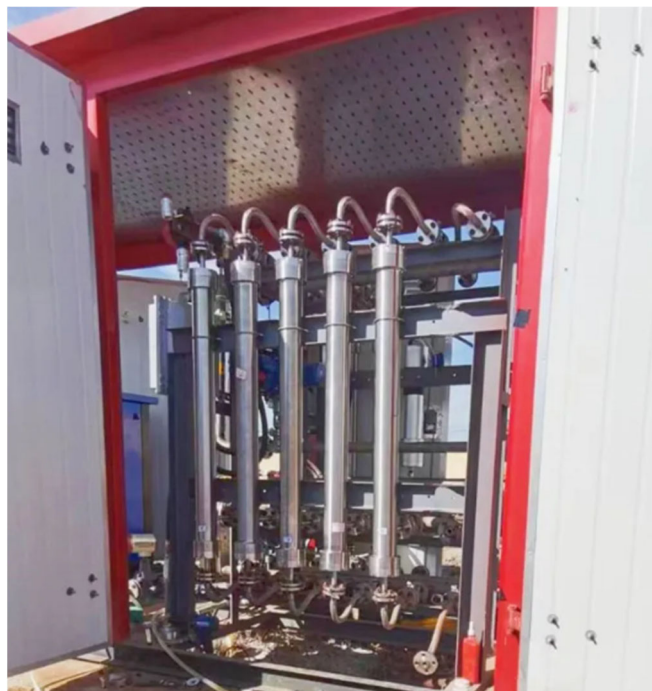
Рис.9.3. Реальна мембранна установка для очистки вуглекислого газу
