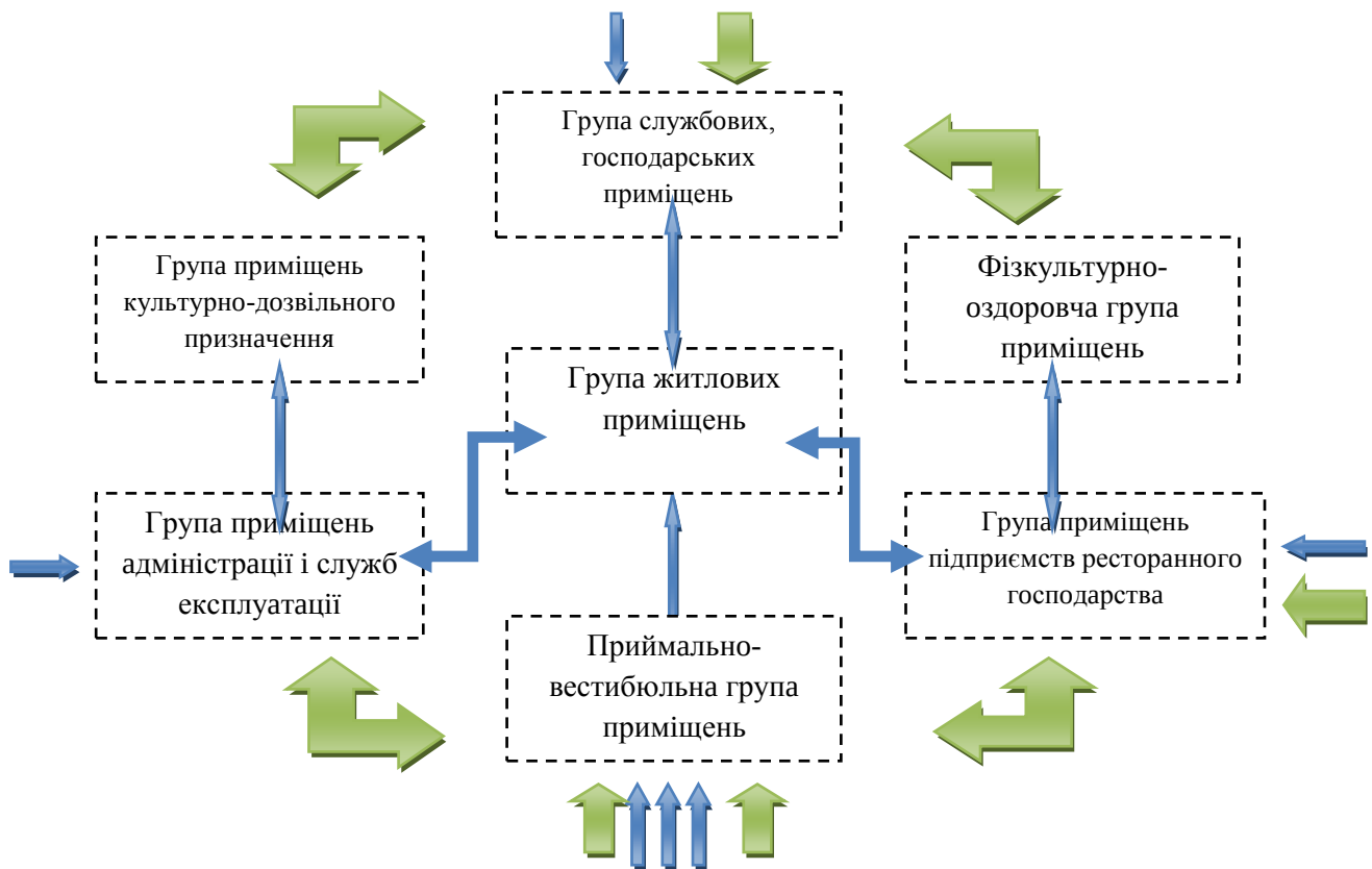
Рис.3.2 – Функціональна схема засобу розміщення
