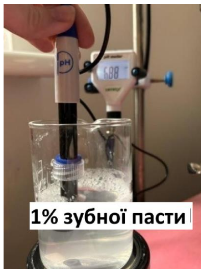
Рисунок 3.5 – Визначення рН за допомогою рН-метра РН-98112 - рН 6,88
