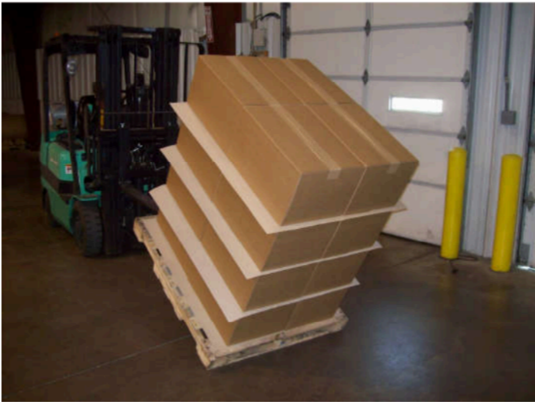
Рис. 1.17 Випробування скріплення транспортного пакету проти ковзальними листами
