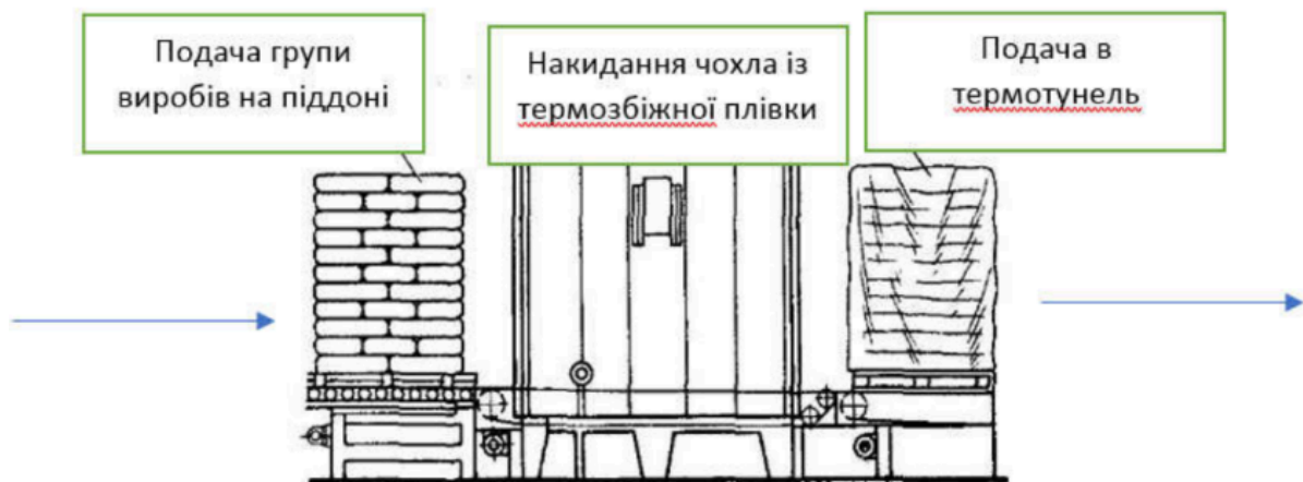
Рис.1.10 Загальна схема скріплення транспортного пакету термозбіжною плівкою з піддоном
