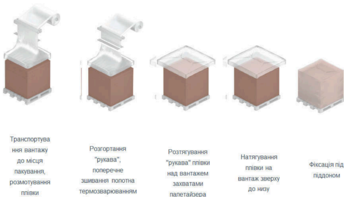
Рис.1.14 Технологія скріплення транспортного пакету СТРЕЙЧ- ХУД плівкою
