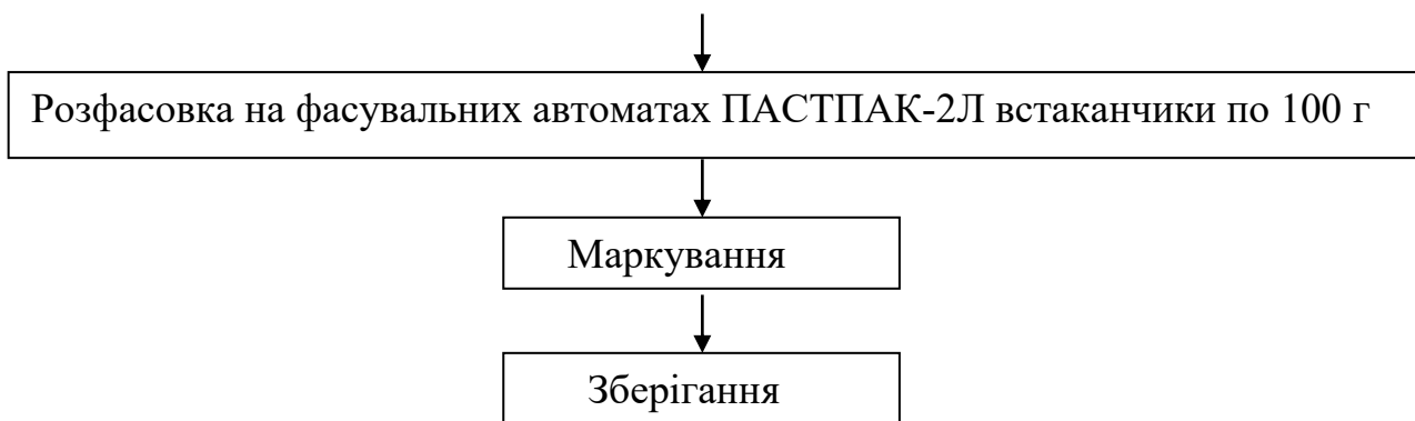
Рис. 3.7. Принципово-технологічна схема отримання сиркових десертів
