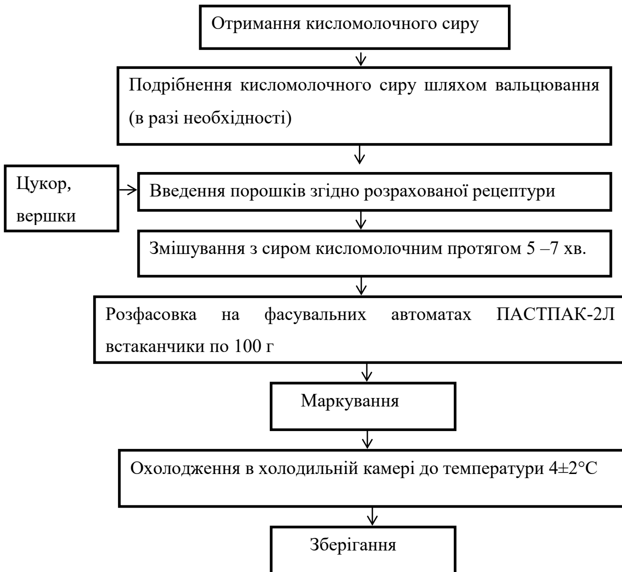
Рис. 3.9. Принципово-технологічна схема отримання сиркового десерту на основі кисломолочного сиру з додаванням порошків з ягід смородини та чорниці
