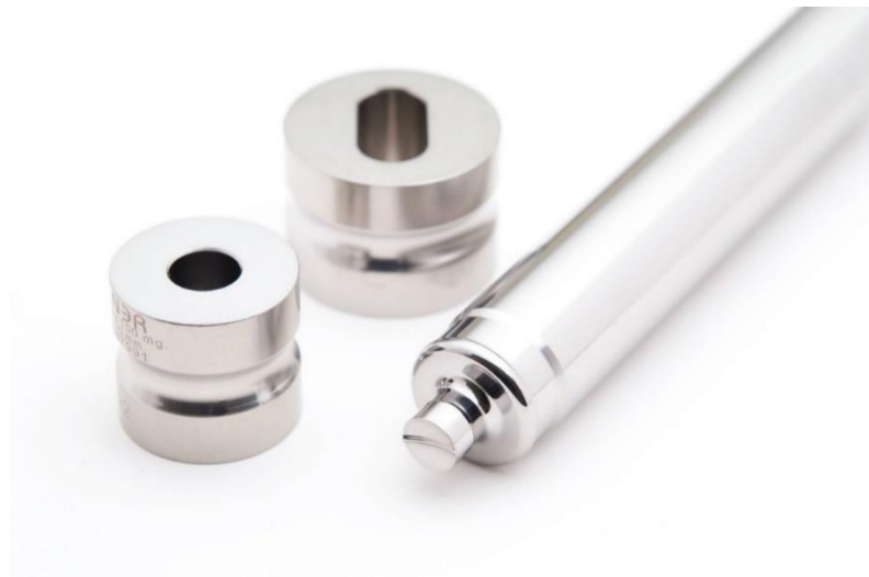
Рис. 1.5. Фотографія пресінструменту - матриці та пуансона
