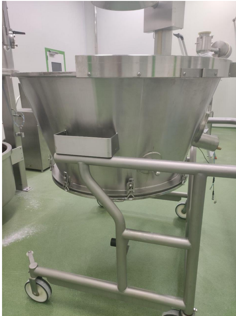
Рис.4.4 Корзина в яку збирається гранулат
