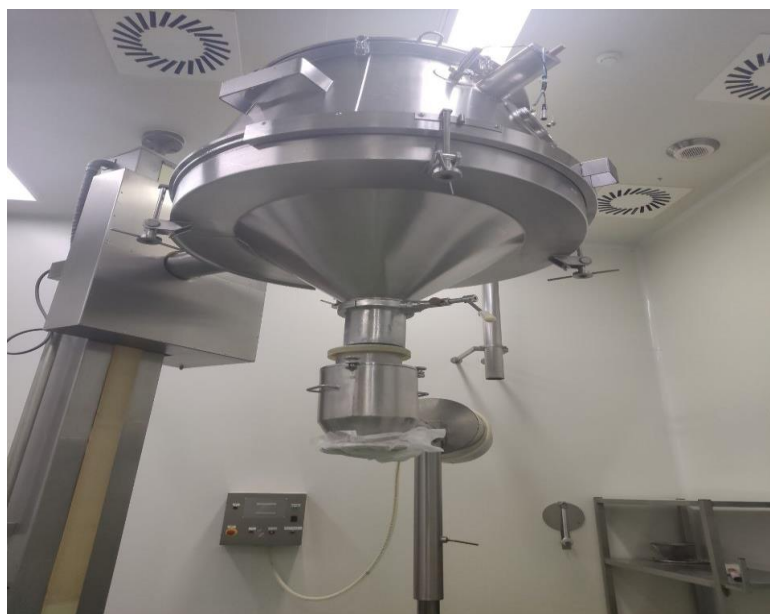
Рис.4.6 Стійка підйомник на якій підіймається корзина для подальшого сухого гранулювання
