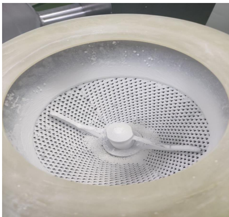
Рис. 4.7 Сито через яке проводиться сухе гранулювання
