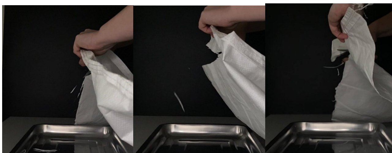
Рисунок 3.4 Розкривання мішків ножицями
