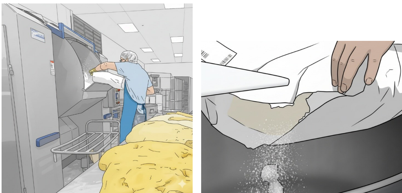
Рисунок 3.2. – Схема розриття мішку над ємністю
