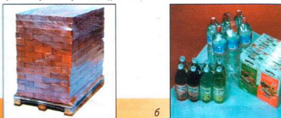
Рис. 3. Скріплення вантажів термоусадковою полімерною плівкою; а - транспортного пакета; б - групову упаковку
