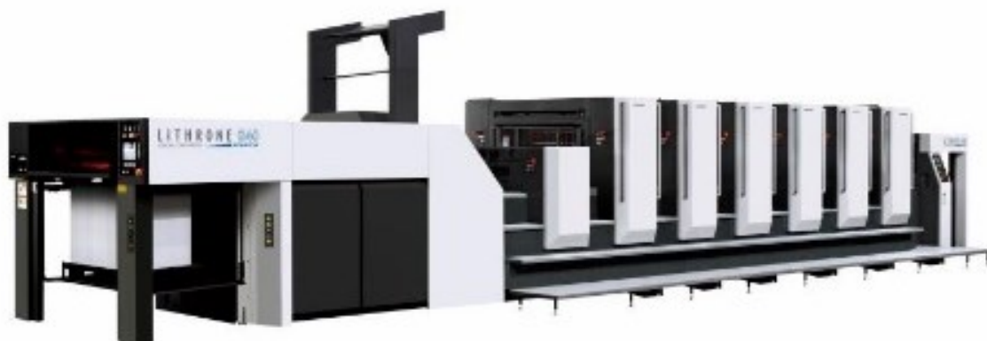
Рис. 4.2. Зовнішній вигляд офсетної друкарської машини LITHRONE G40 Advance
