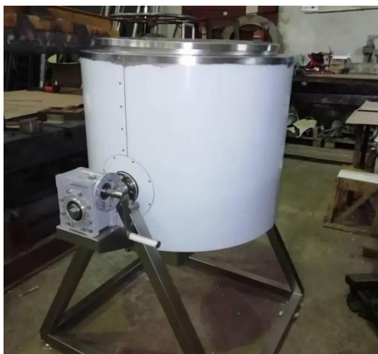
Рисунок 4.5 – Барабанний змішувач для сипких продуктів
