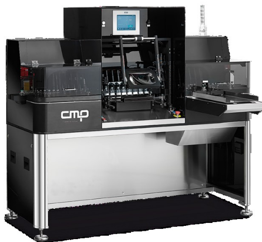
Рис.9.7. Інспекційна машина для ампул SV [157]
