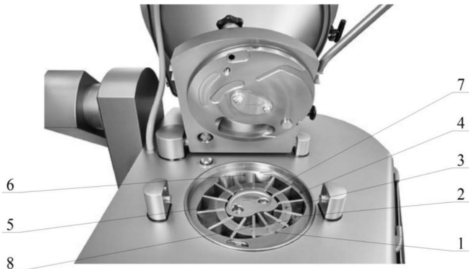
Рис. 1.12. Система нагнітання лопатевого типу компанії «Handtmann»:
