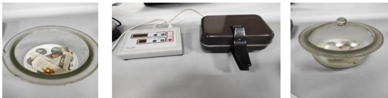
Рис. 2.7. Визначення вологості мармеладу на приладі Чижова.
