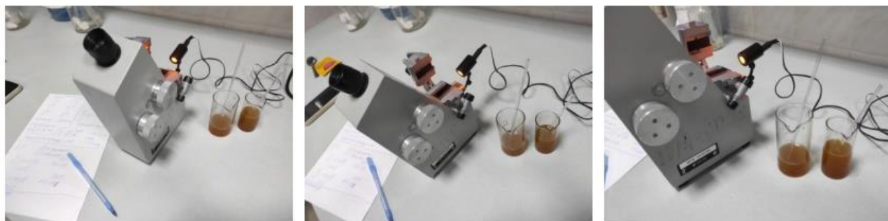
Рис. 2.8. Визначення масової частки сухих речовин рефрактометричним методом.
