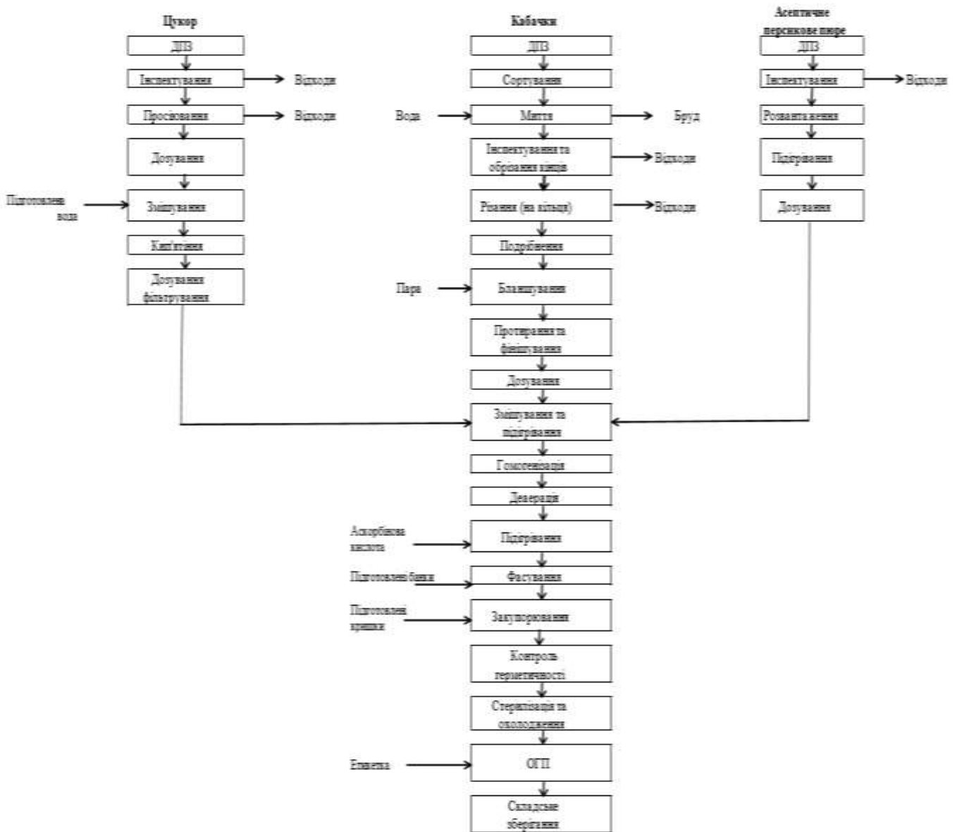
Рисунок 1.1. – Технологічна схема виробництва консервів «Пюре із кабачків та персиків «Аромат»
