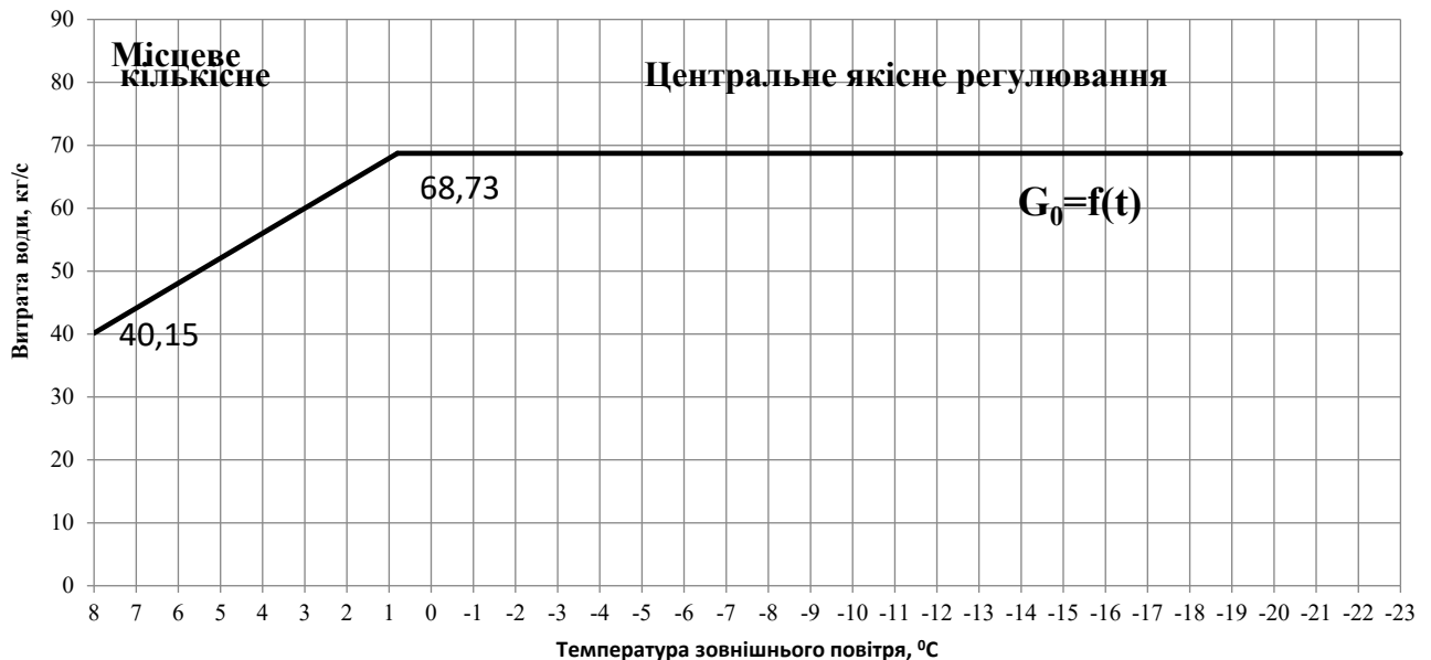
Рис. 1.3 Графік зміни температури і витрати мережної води на опалення в залежності від температури зовнішнього повітря
