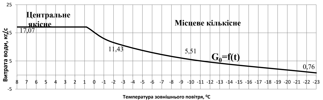
Рис. 1.5 Графіки залежності витрати мережної води на ГВП і температури мережної води після підігрівників ГВП 1-го і 2-го ступеня від температури зовнішнього повітря
