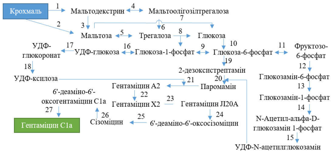
Рис.3.2. Схема біотрансформації крохмалю в гентаміцин [31-33]
