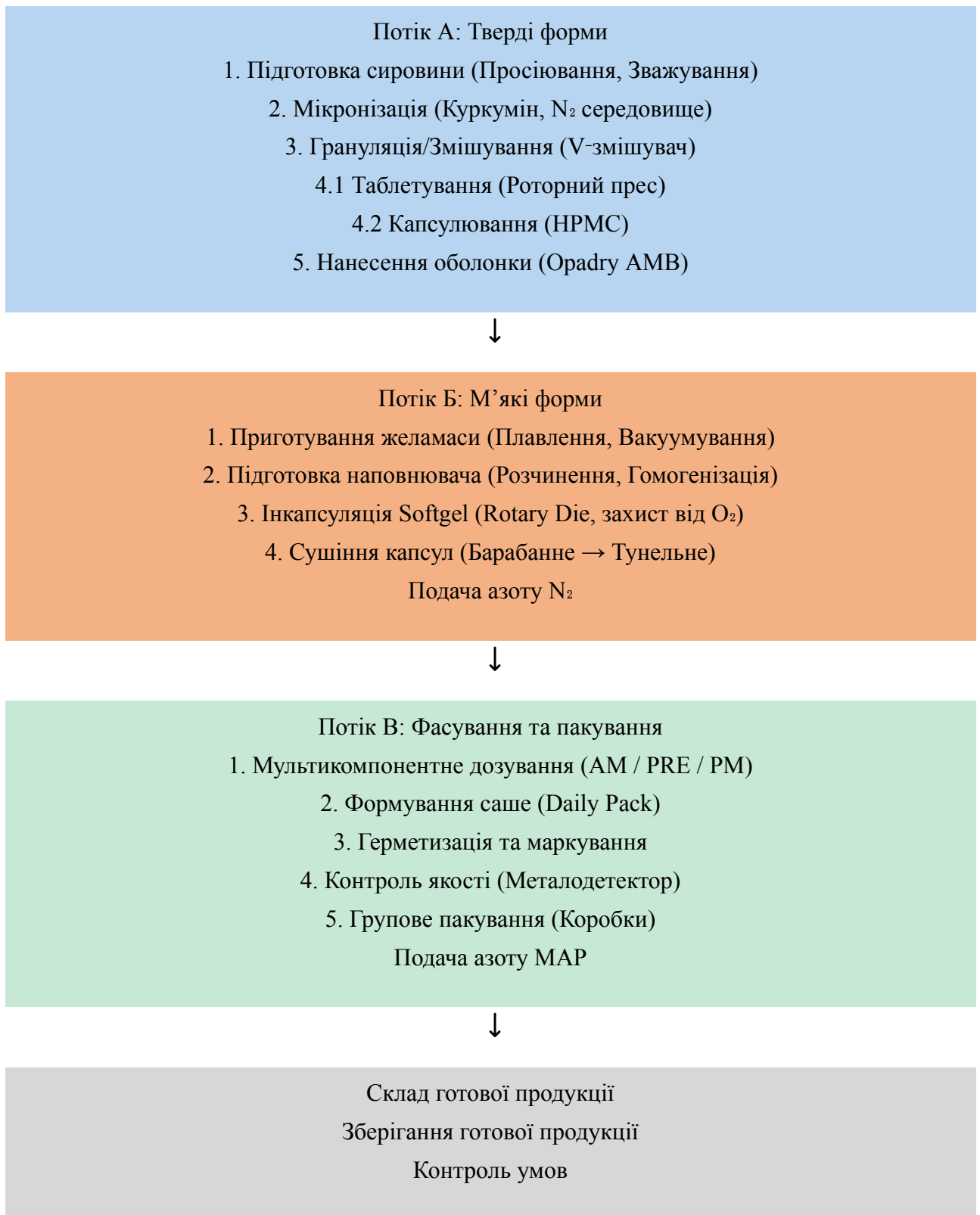
Рис. 3.3. Принципова технологічна схема виробництва комплексу «SCP»
