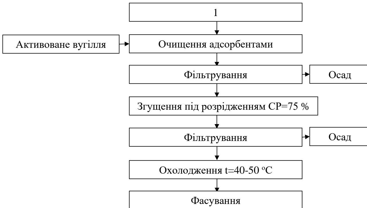
Рис. 3.1. Принципово технологічна схема виробництва глюкозно-фруктозного сиропу
