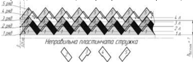
Рис. 4. Схема зрізання неправильної пластинчатої стружки (плоскої соломки)
