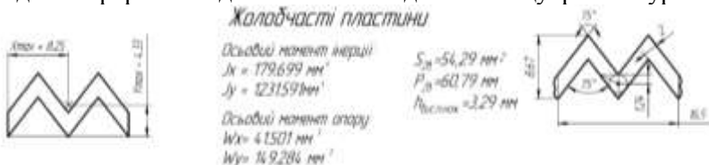
Рис. 1. Основні геометричні характеристики стружки у формі жолобчастих пластин
