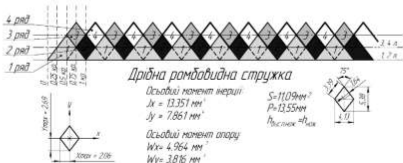
Рис. 6. Схема зрізання та основні геометричні характеристики дрібної ромбовидної стружки
