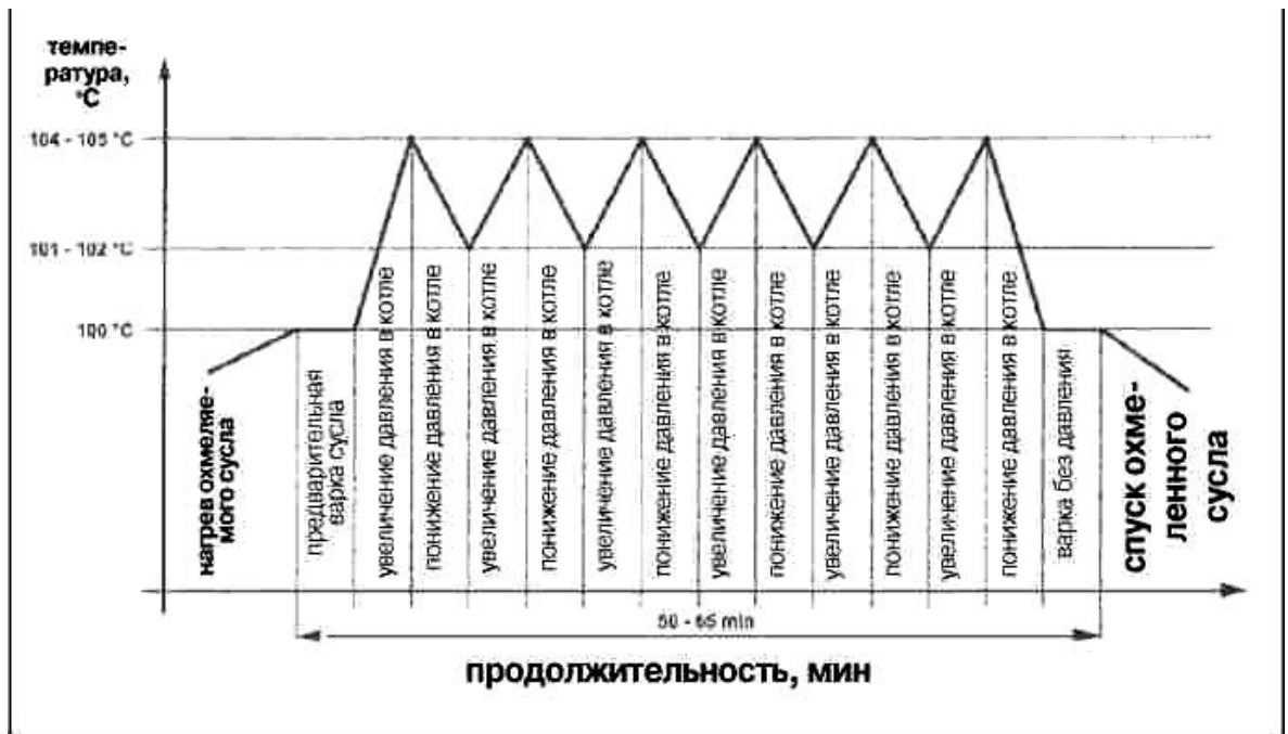
Рис. 2.5 – Спосіб динамічного кип'ятіння суслу за низького надлишкового тиску.
