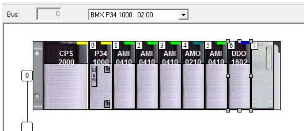
Рис.3.15. Розміщення модулів у шасі
