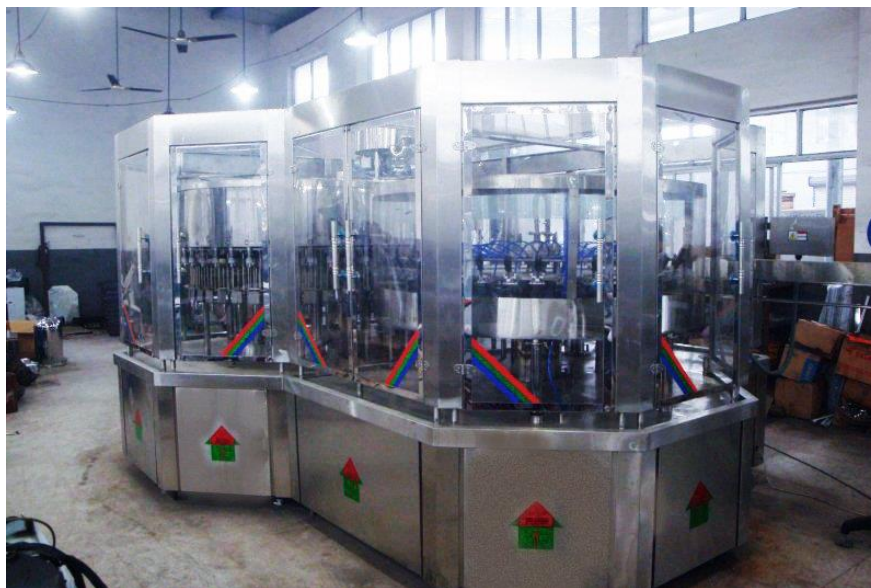
Рис.1.14. Моноблок розливу газованої (негазованої) води XGF (DXGF) 40–40–12
