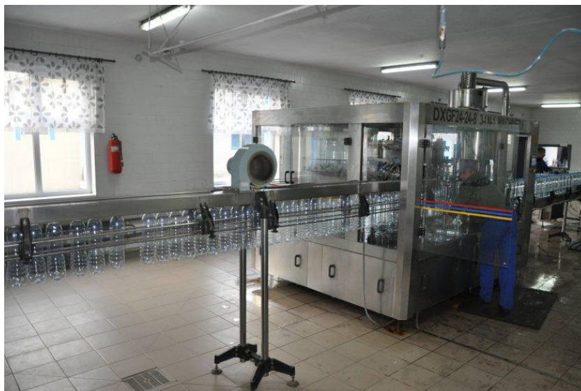
Рис.1.12. Моноблок розливу газованої (негазованої) води DXGF 24–24–8
