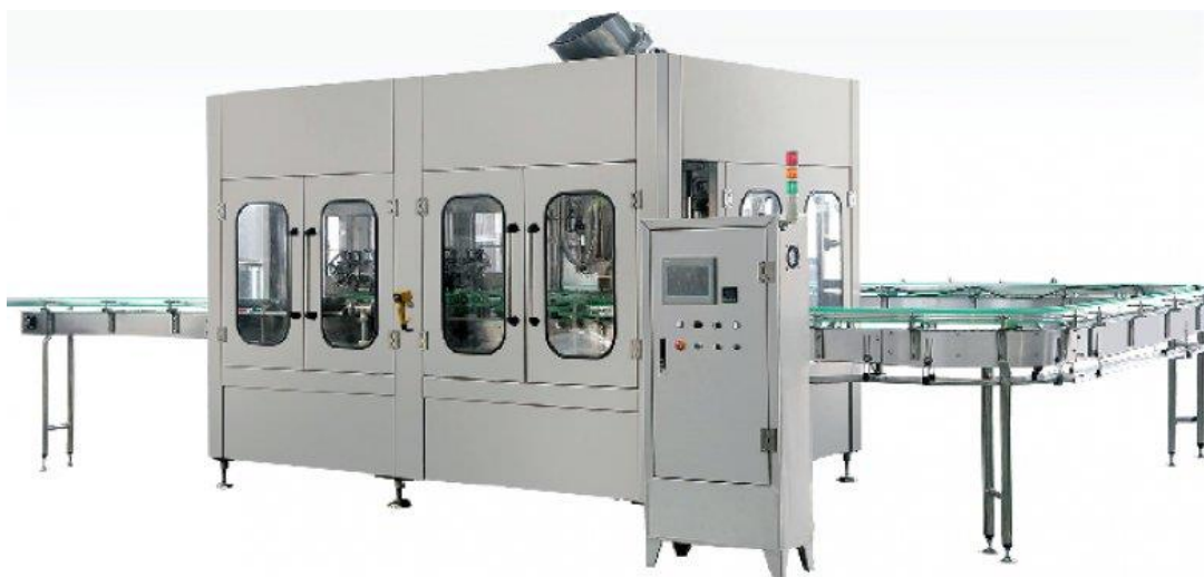
Рис.1.17. Моноблок для розливу пива BGF 18/6
