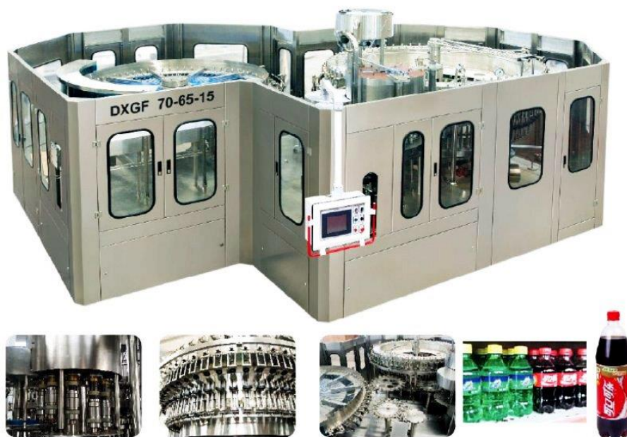
Рис.1.19. Моноблок для розливу газованих напоїв серії DXGF
