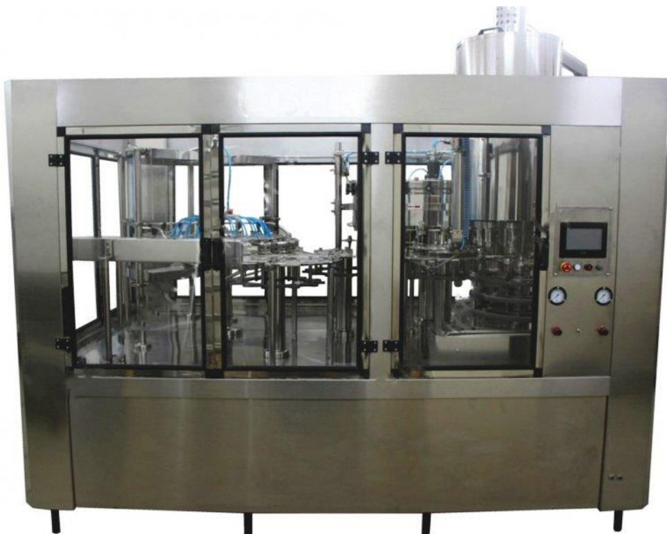
Рис. 1.10. – Моноблок розливу газованої (негазованої) води DXGF 12–12–5
