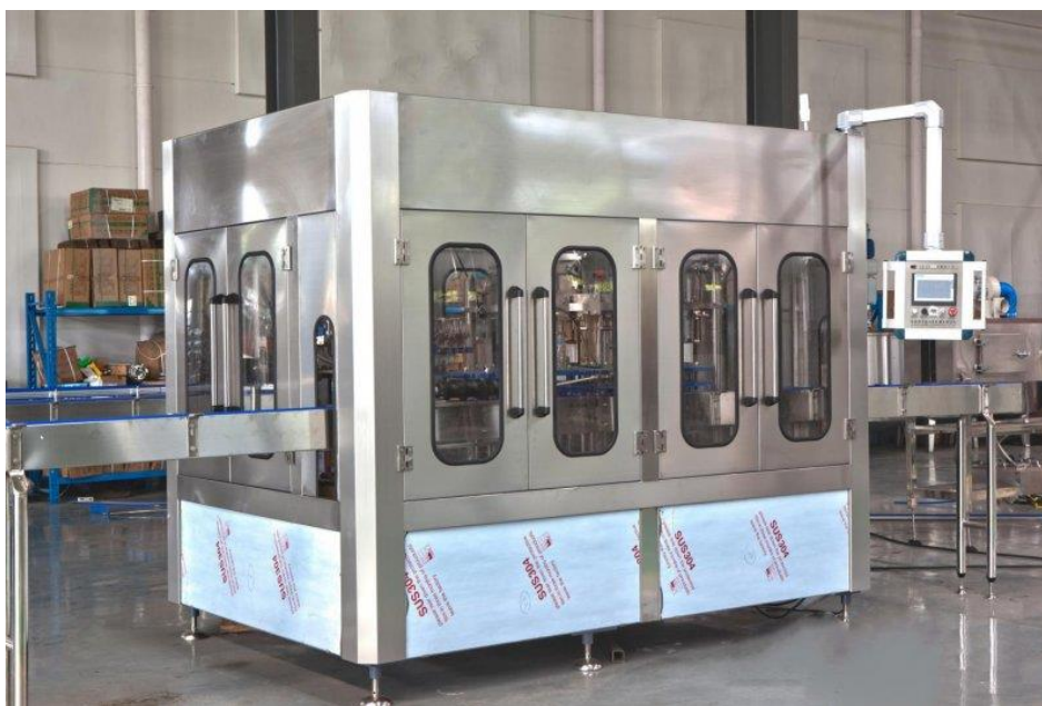
Рис.1.13. Моноблок розливу алкогольних напоїв у скло пляшку VXGF 18-18-6
