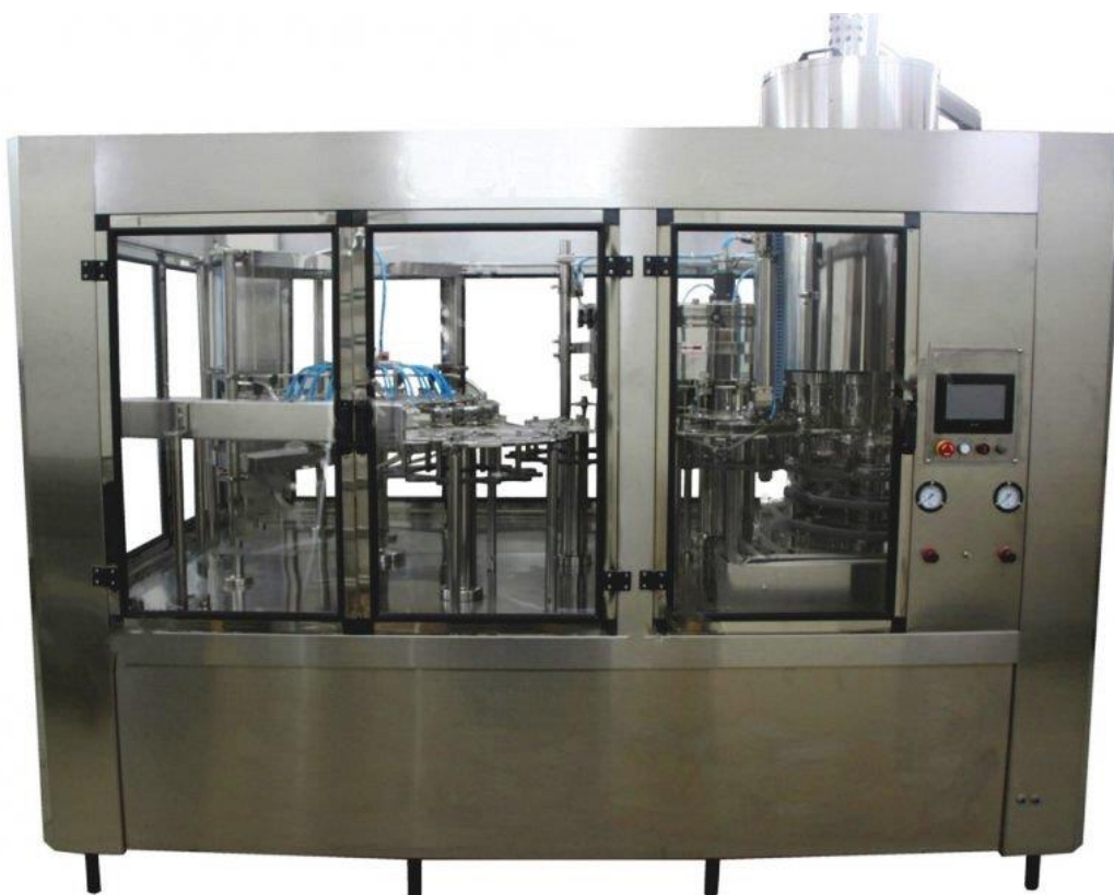
Рис. 1.10. – Триблок & Моноблок розливу газованих / негазованих напоїв в ПЕТ DXGF 18–18–6
