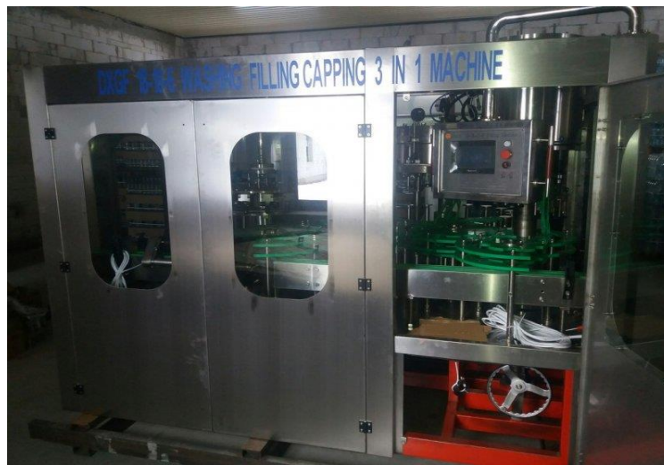
Рис.1.11. Моноблок розливу газованої (негазованої) води (скляна пляшка) DXGF 18–18–6
