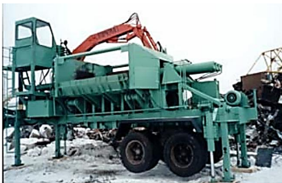
Рис. 5. Прес-пакетувальник встановлений на напівпричепі
