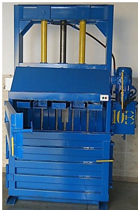
Рис. 3. Преса з двома гідроциліндрами (ПП “Обухівміськввторресурси”).
