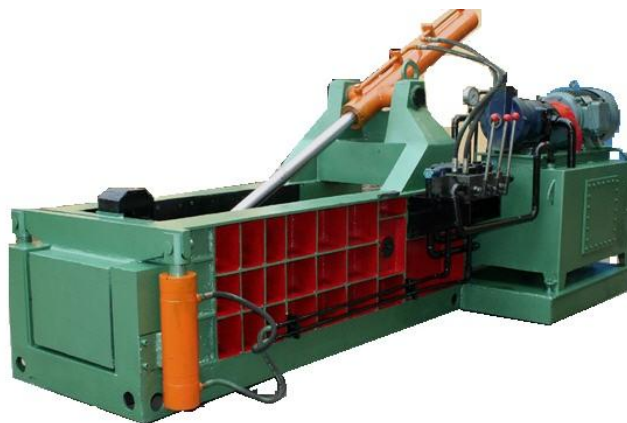
Рис. 7. Прес з функцією підйому гідроциліндра (коливальний рух) при завантаженні сировини
