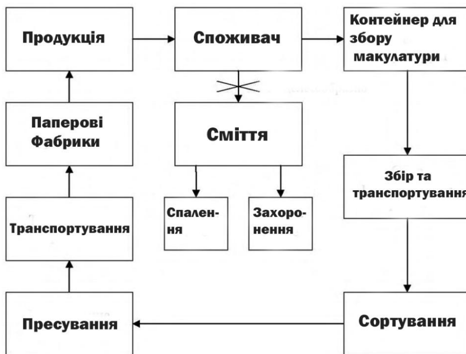
Рис. 1. Схема взаємозв'язку основних ланок у системі збору та переробки макулатури.
