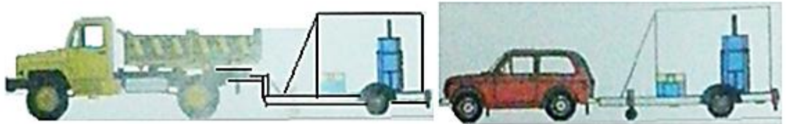
Рис. 4. Мобільні преса які монтуються на транспортних засобах.
