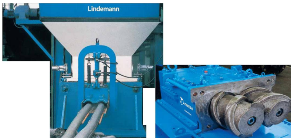
Рис. 10. Двох шнековий прес фірми «Metso Lindemann GmbH» (Німеччина)
