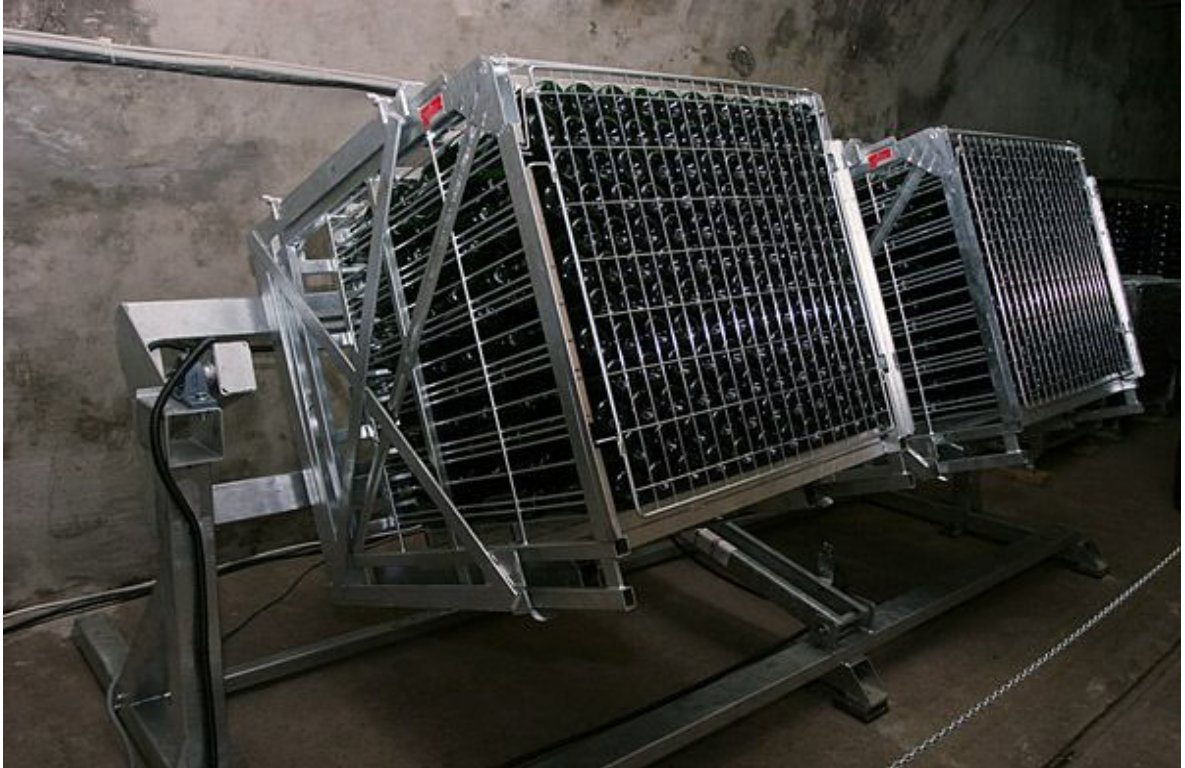
Рис. 2.2 – Установка для ремюажу « Gyropalette »
