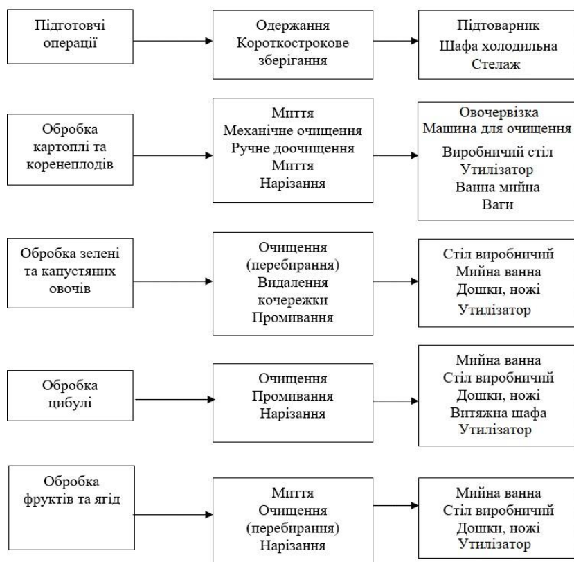
Рис.2.2 - Структурно-технологічна схема виробничого процесу овочевого цеху
