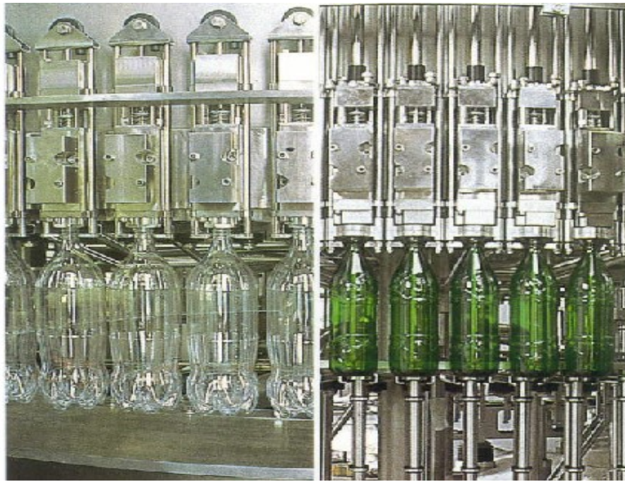
Рис. 3 Вузли машин фасування напоїв машин Eurotronika FM і FM-LT «Simonazzi» (Parma, Італія).
