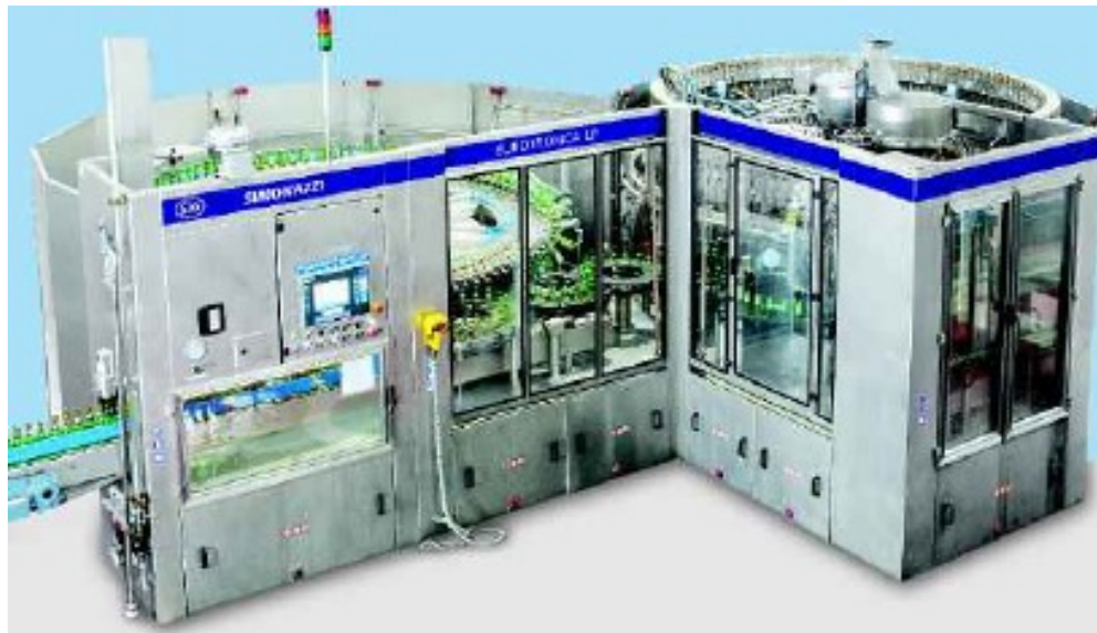
Рис. 4 Фасувально-укупорочний автомат Eurotronika LP «Simonazzi» (Parma, Італія).
