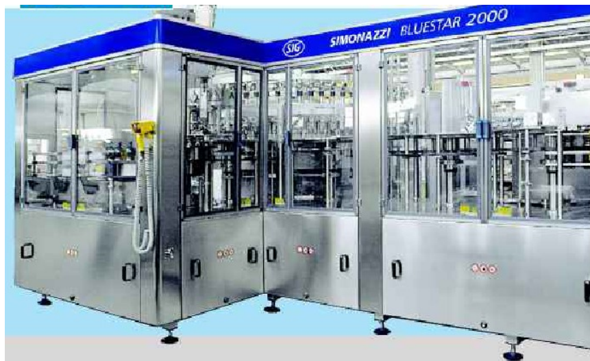
Рис. 5 Система дозування напою у автоматі Starcans-2000 «Simonazzi» ( Парма, Італія).
