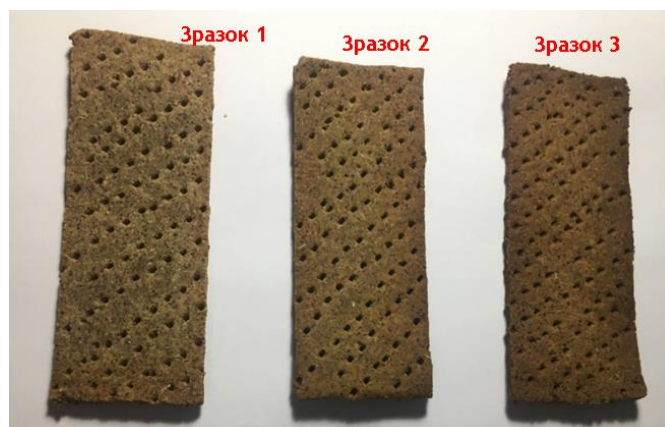
Рис. 2.10 – Зовнішній вигляд модельних зразків (зразок 1 – тривалість запікання – \tau=15\text{хв} ., зразок 2 – \tau=20\text{ хв} зразок 3 – \tau=25\text{хв} )
