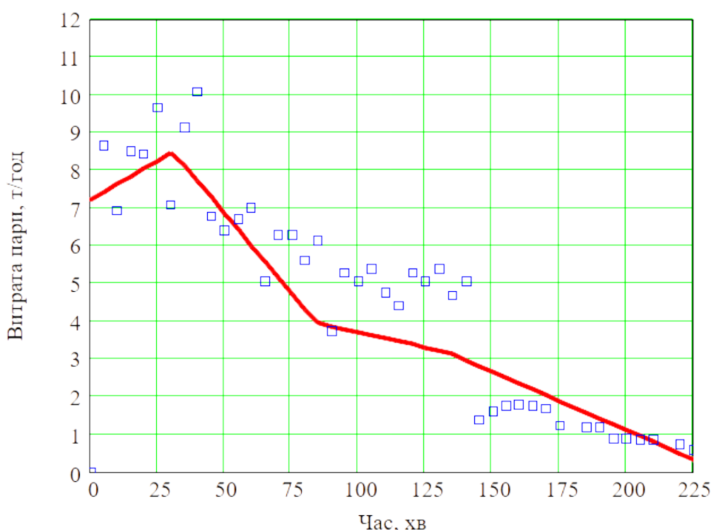
Рис. 1.5. Змодельований графік зміни витрати пари протягом циклу варіння утфеля I продукту
