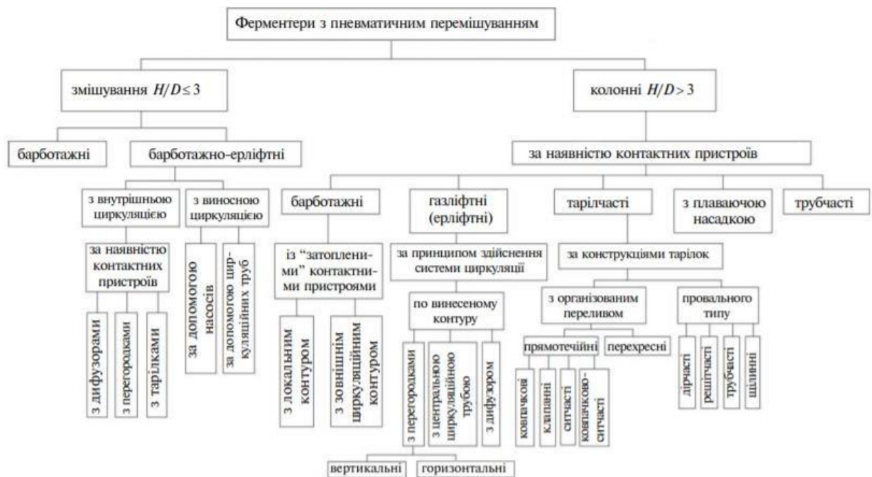
Рис.1.1. Схема класифікації ферментерів з пневматичним перемішуванням
