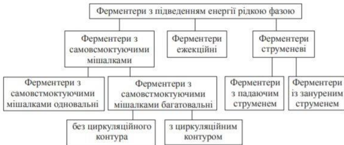
Рис.1.3. Класифікація ферментерів з підведенням енергії рідкою фазою
