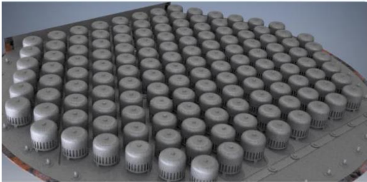
Рис. 1.4. Принцип роботи бульбашкових тарілок.
