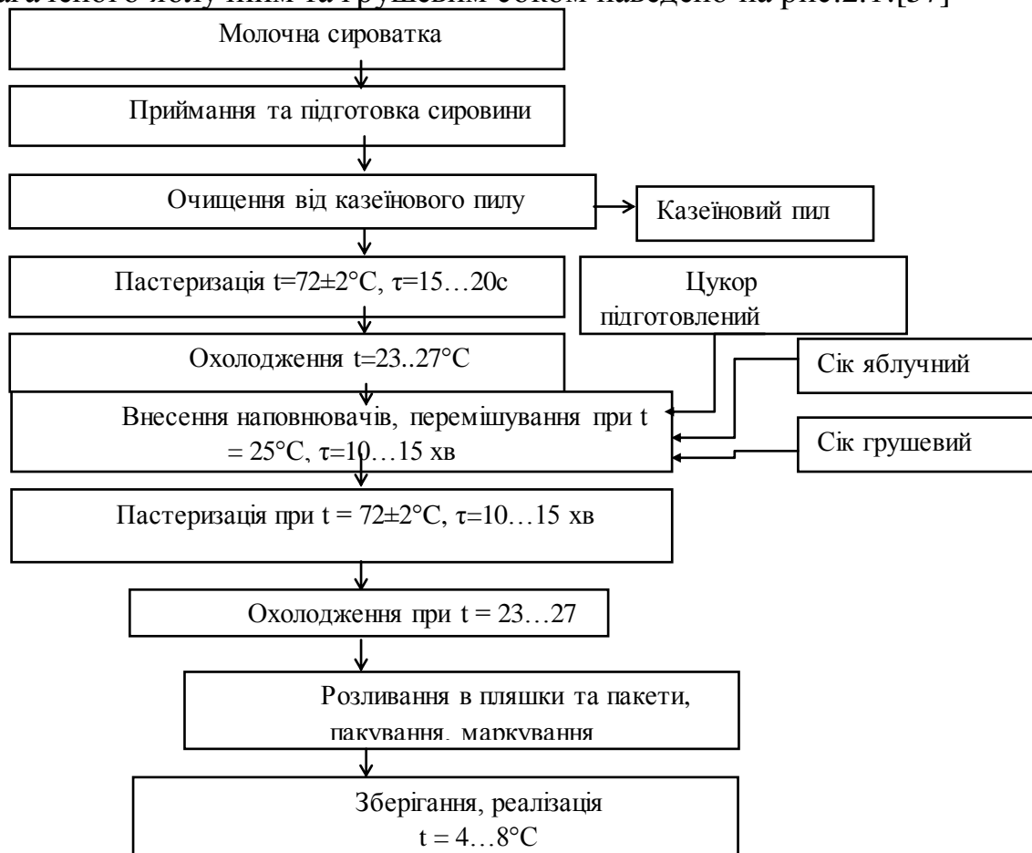
Рис 2.1. Принципово-технологічна схема виробництва сироваткового напою збагаченого яблучним та грушевим соком
