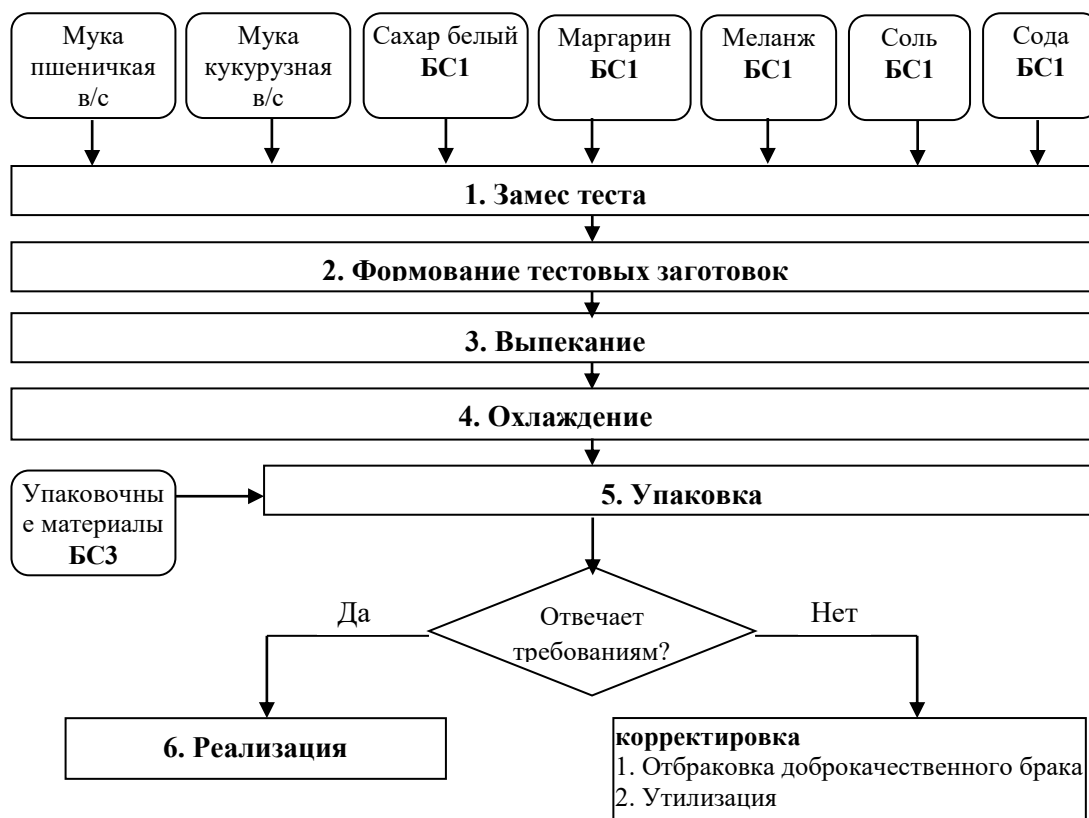
Рисунок 4. Блок-схема производства печенья «Кукурузка»
