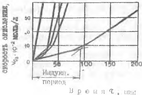
Рис.5. Кинетика поглощения кислорода во времени для L1-смазок: 1 — без добавок; 2 — 10 % Si(OH)_2 ; 3 — 10 % Si_2O ; 4 — 10 % SiO ; 5 — 10 % ПМС-2.
