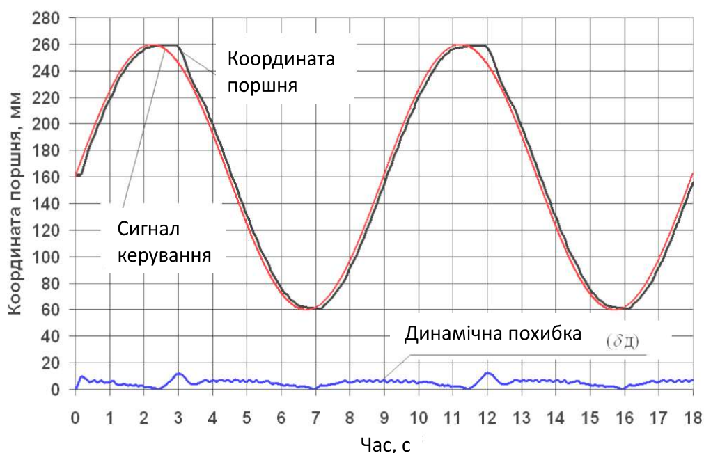
Рисунок 2 – Графічна інформація про положення вихідного елемента виконавчого механізму (затвора регулюючого органу). Похибка позиціонування: |\delta_{\text{п}}| \leq 1 \text{ мм} , перерегулювання: \sigma_i \leq 7 \%
