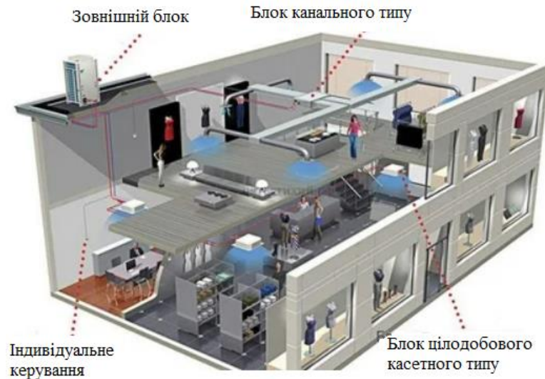
Рис.4.3 – Мультизональна система кондиціонування
