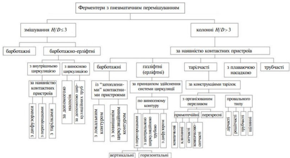
Рис.1.1. Схема класифікації ферментерів з пневматичним перемішуванням
