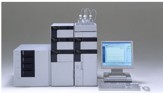
Рис. 9.3. Високоєфективний рідинний хроматограф HPLC-sistema-LC-20-Prominence (ліворуч) [94], колонка Aminex HPX-87H (праворуч)[100].
