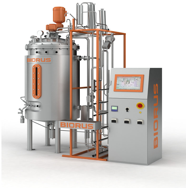
Рис 5.1 Промисловий ферментер фірми «BIORUS» об'ємом 100 л [41].
