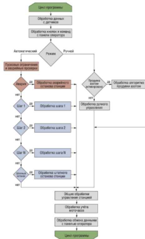
Рисунок 5.1 – Передпусковий алгоритм роботи компресора
