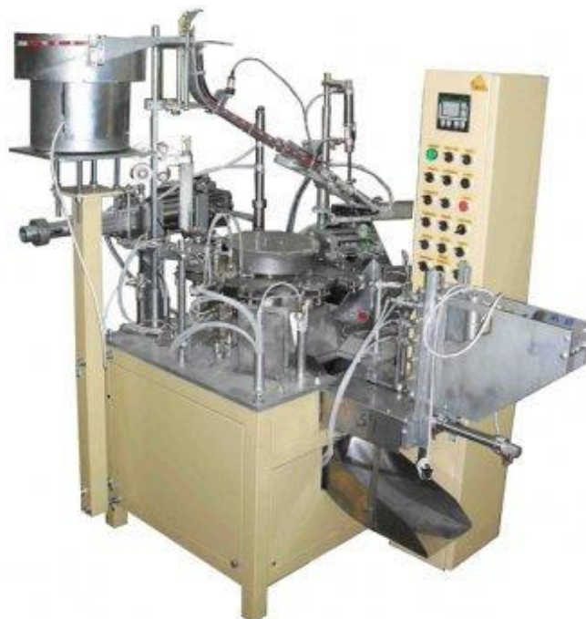
Рис. 1.1. Автомат ДП–Н для фасування у пакети «дой–пак»
