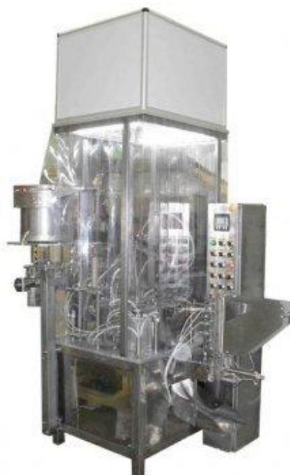
Рис. 1.2. Автомат ДП для фасування у пакети «дой-пак»
