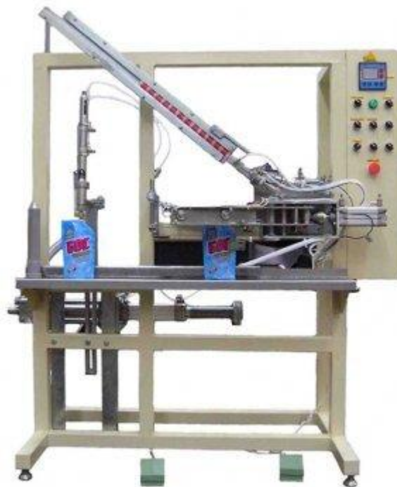
Рис. 1.4. Напівавтомат ПДП-Н для пакування у пакети «дой-пак»
