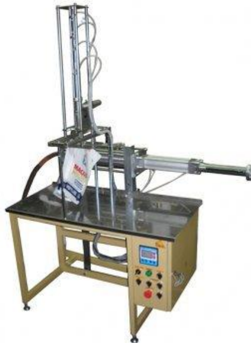
Рис. 1.6. Напівавтомат ПДП–ФН для пакування у пакети «дой–пак»
