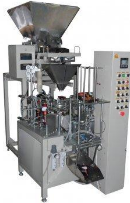
Рис. 1.3. Автомат ДП–В для фасування у пакети «дой–пак»
