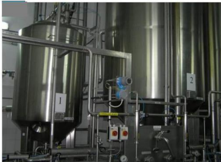
Рис. 1.3 — Загальний вигляд апаратів чистої культури 1 — АЧК-1; 2 — АЧК-2
