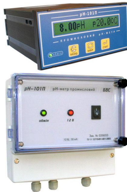
Рис. 2.6 Загальний вигляд потенціометричного рН-метра
