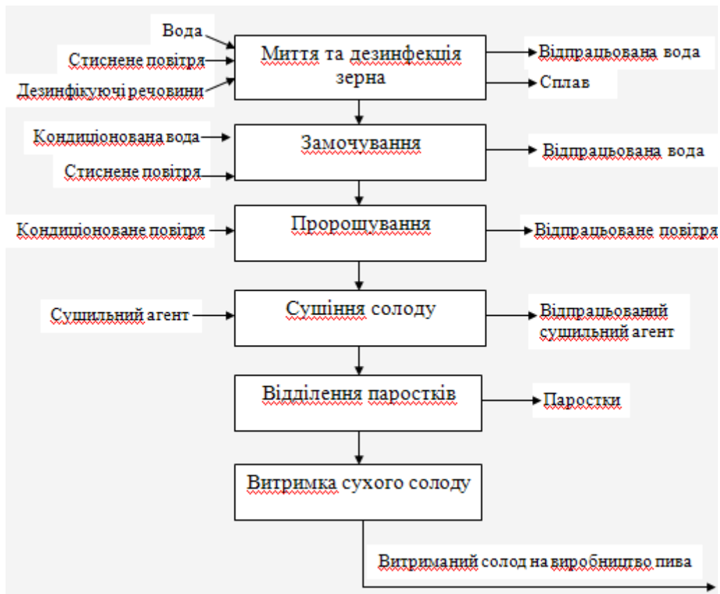
Рис. 2.1. Схема виробництва солоду.
