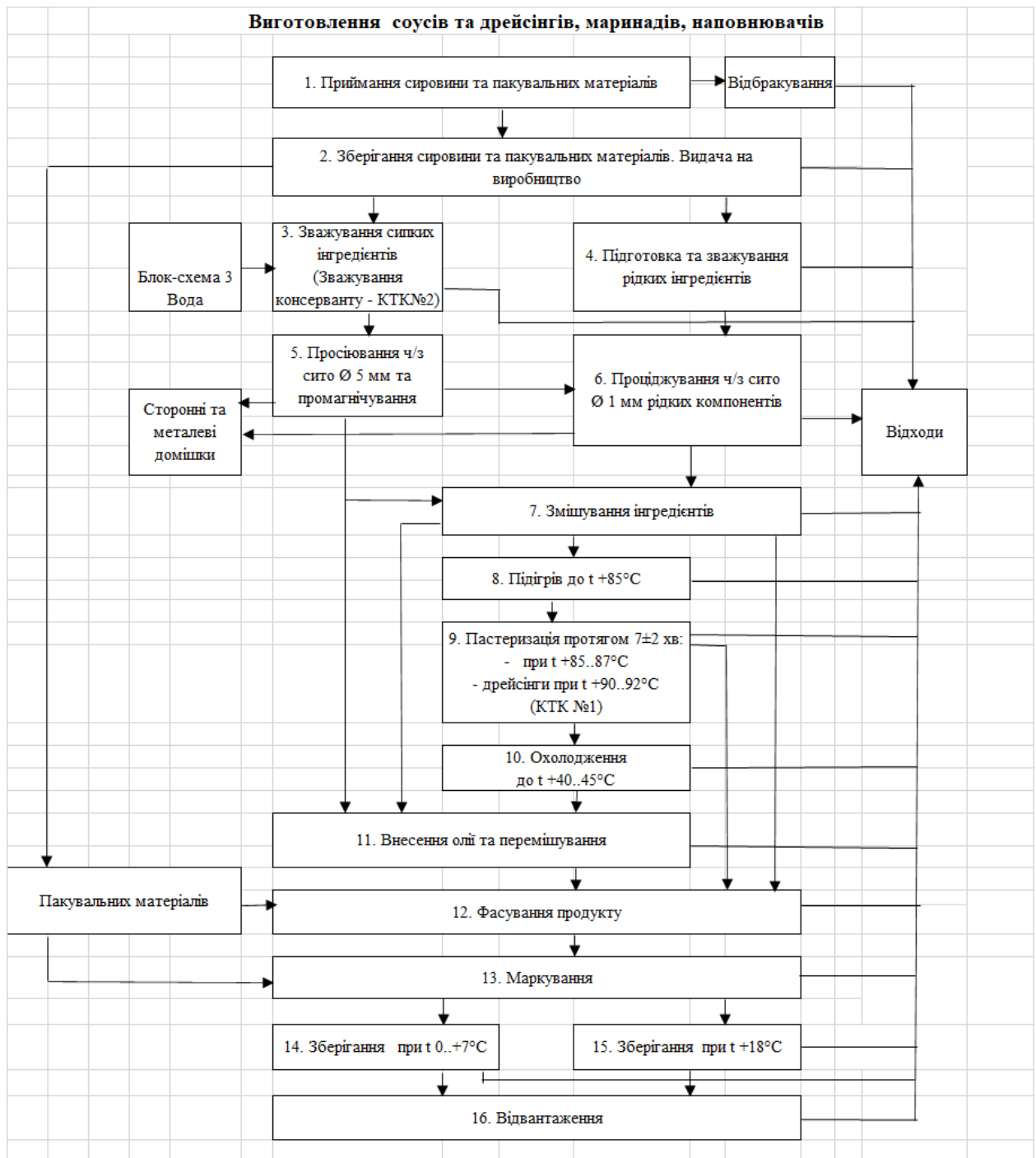
Рис. 3.5.2. Технологічна схема виробництва соусів
