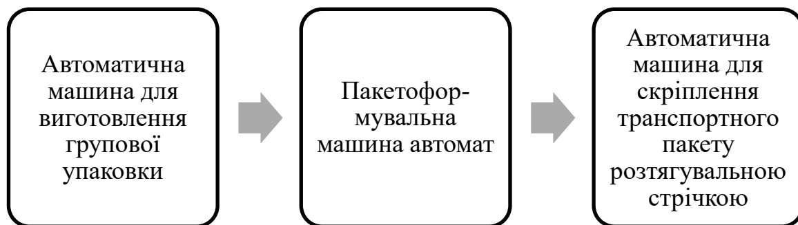
Рис. 3.1. Технологічна схема лінії виготовлення транспортних пакетів
