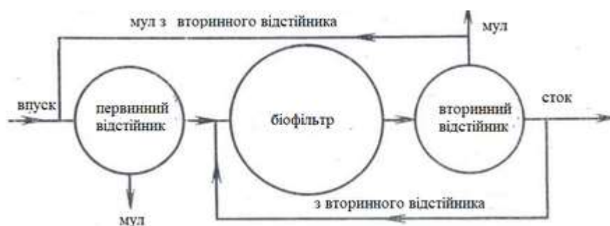
Рис.9.1. Схема одноступінчатої роботи біофільтра з рециркуляцією [95]
