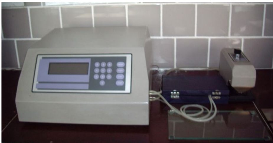
Рис.2 Загальний вигляд лабораторної установки Messmer Buchel K513 для визначення повітропроникненості повітря через пористі матеріали
