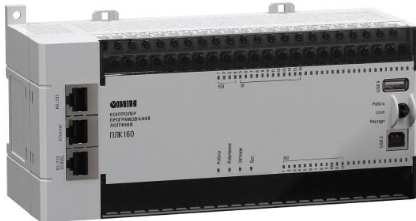
Рисунок 3.1 – Зовнішній вигляд контролера ОВЕН ПЛК160
