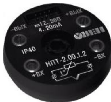
Рисунок 2.3 – Нормувальний перетворювач температури НПТ-2
