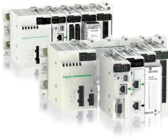
Рис.2.1.21 – загальний вигляд контролера Modicon M340
