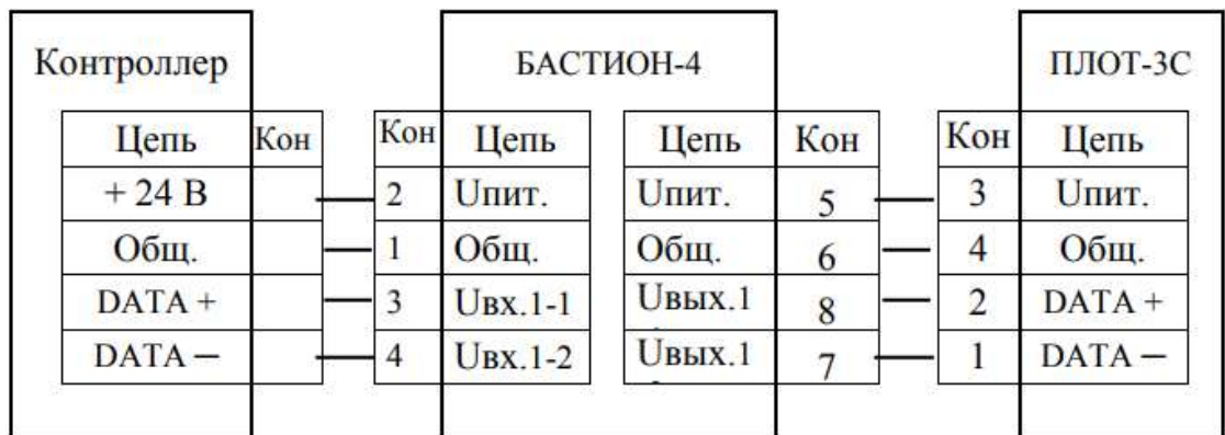
Рис. 2.1.17 – Схема підключення спиртоміру
