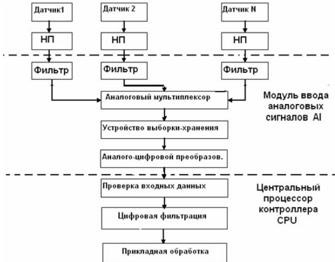
Рис.6 Схема обработки аналогового сигнала при введении в контролер
